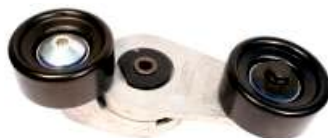
VTO8000 - VTO Tensor Completo - Direção Hid. Gol, Parati, Santana, Saveiro AP 1.6, 1.8, 2.0, 2.0 16V 96/... - c/ ar Dimensões: 76,2x31 cm
